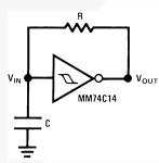
$$t_1 \approx RC \, ln \, \frac{V_{T+}}{V_{T-}}$$
