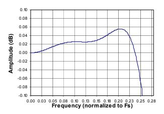
Figure 28. Quad-Speed Passband Ripple
