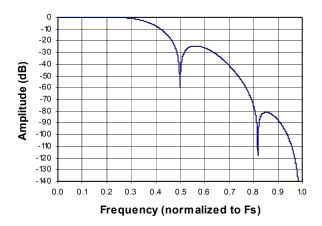
Figure 25. Quad-Speed Stopband Rejection
