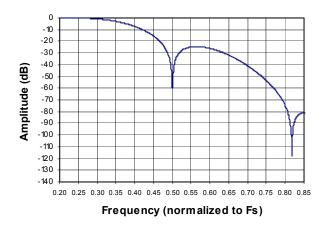
Figure 26. Quad-Speed Stopband Rejection
