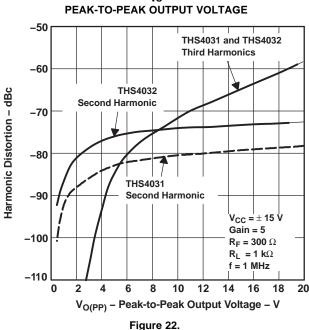
HARMONIC DISTORTION PEAK-TO-PEAK OUTPUT VOLTAGE
