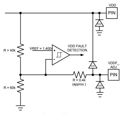
Figure 18: VDD<sub>FLT\_ADJ</sub>
