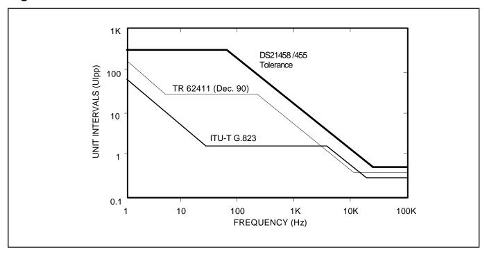
Figure 25-10. Jitter Attenuation (T1 Mode)
