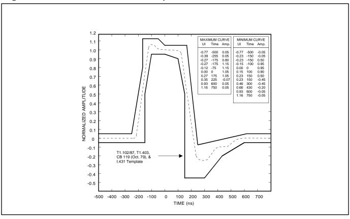
Figure 25-9. Jitter Tolerance
