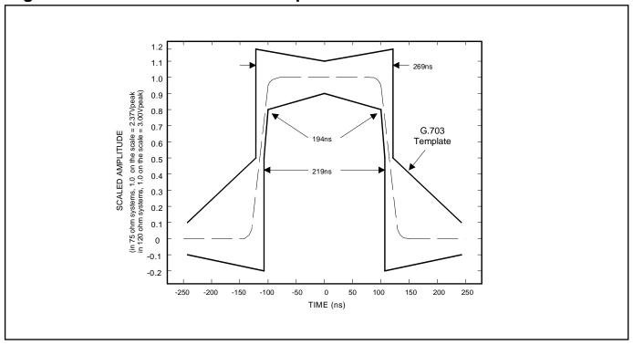
Figure 25-8. T1 Transmit Pulse Template
