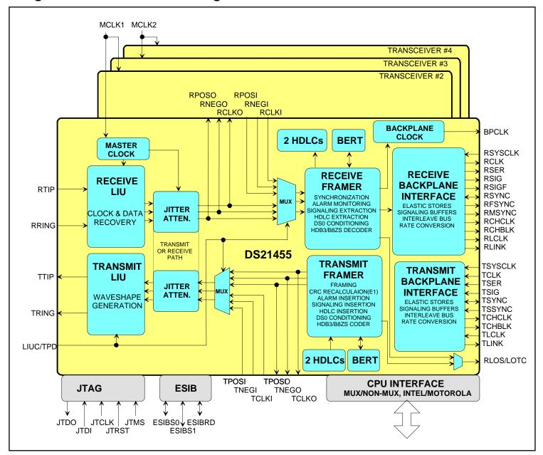
Figure 3-2. DS21455 Block Diagram
