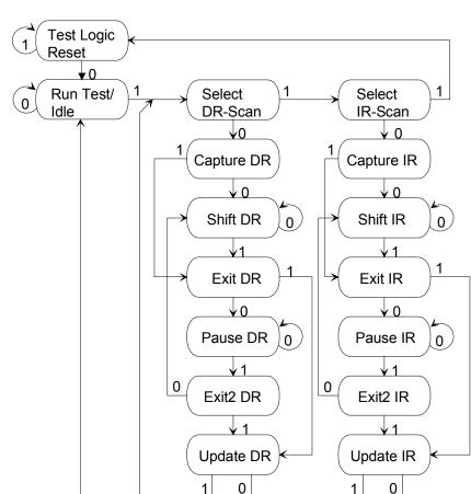
Figure 21-2. TAP CONTROLLER STATE MACHINE
