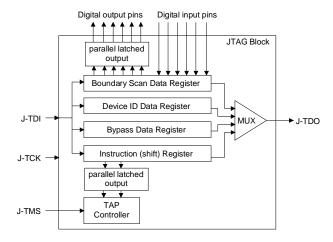
Figure 23. JTAG Circuitry Block Diagram
