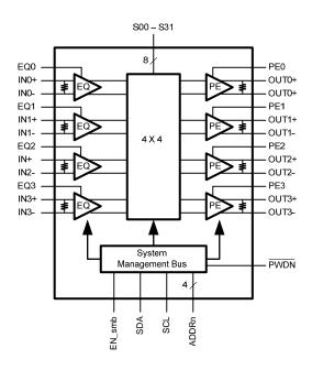
Figure 3. DS25CP104 Block Diagram
