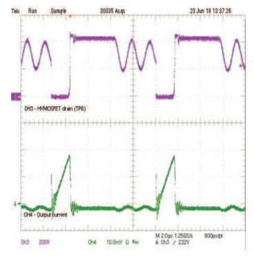
Figure 11. Switching-Node Waveform (CH4 - 200 mA/10 mV)
