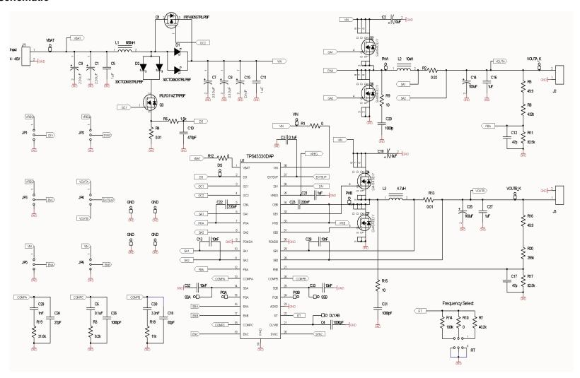
Figure 12. TPS4333xEVM Schematic
