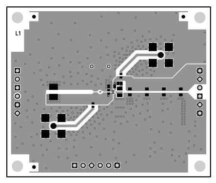
Figure 11. TPS62690/1/2/3EVM Top-Side Copper (Top View)
