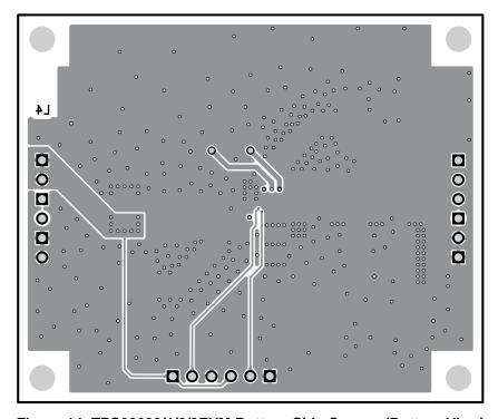
Figure 14. TPS62690/1/2/3EVM Bottom-Side Copper (Bottom View)
