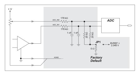
Figure B-6. A/D Converter Inputs
