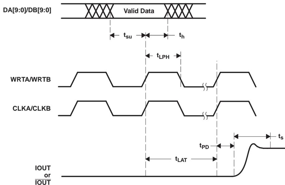
**Figure 16. Dual-Bus-Mode Operation**
