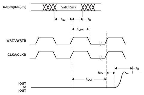
Figure 16. Dual-Bus-Mode Operation
