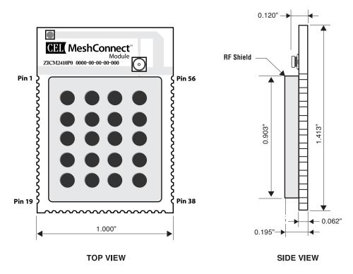
MeshConnect<sup>™</sup> Module / MeshConnect<sup>™</sup> Extended Range Module w/PCB Trace Antenna
